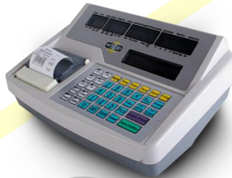
Fig. - 14 - Paso 2: Colocar el rollo de papel continuo con un pequeño tramo por fuera de la tapa de acceso y cerrar dicha tapa, el indicador estará listo para imprimir.
