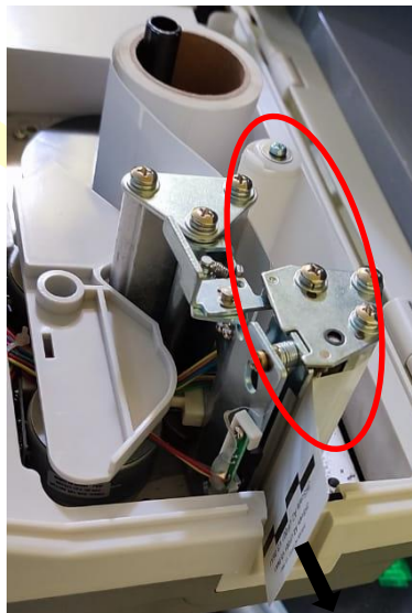
Fig. 12 – Sistema de re-embobinado del papel de respaldo.
