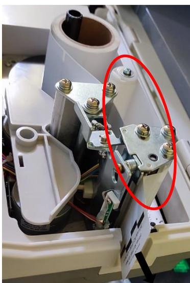
**Fig. 12 – Sistema de re-embobinado del papel de respaldo.**
