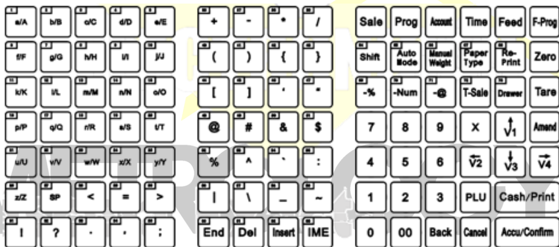
Fig. 1: Teclado de Báscula Electrónica MEGA BIE-30T.
